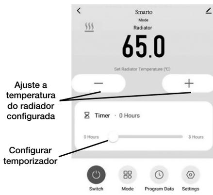
Figura 10 | Interface de modo de radiador na aplicação INOW
